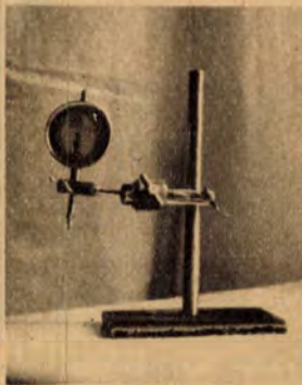
Barkács műszerállvány, indikátor-óra használatához
